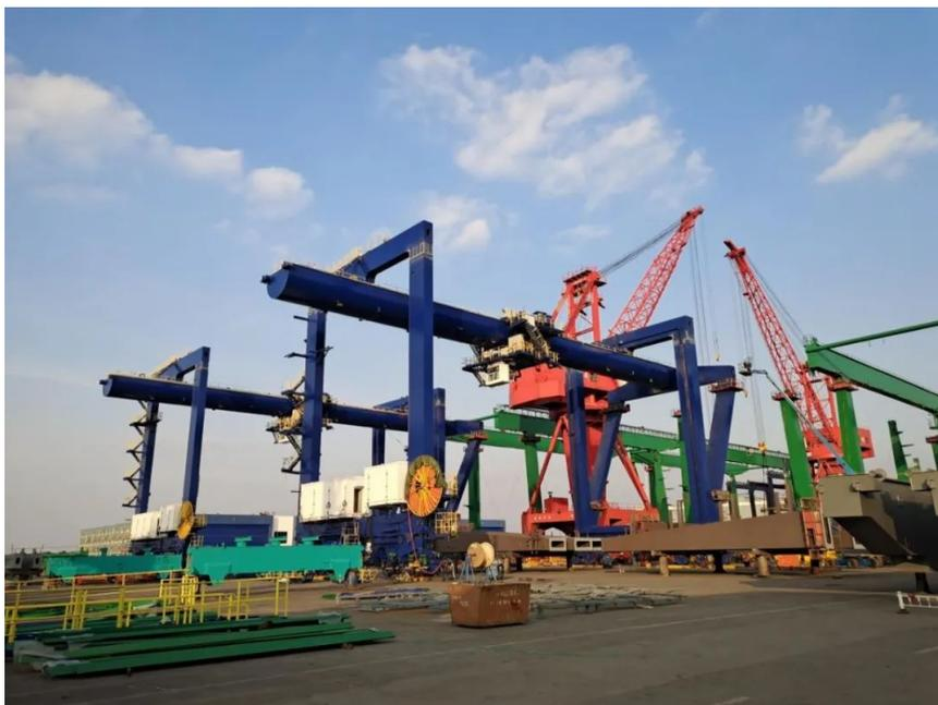
该项目首次采用独具特色的半圆形大梁，并辅以公司首创的新八绳 MAX 小车。采用半圆形大梁结构能显著降低整机迎风载荷；此外，新八绳 MAX 缠绕系统与常规缠绕系统相比，小车总重可降低约 30%，其电气控制系统算法简单、控制要求低、适配自动化的特性，为用户后续打造自动化港口提供保障。
