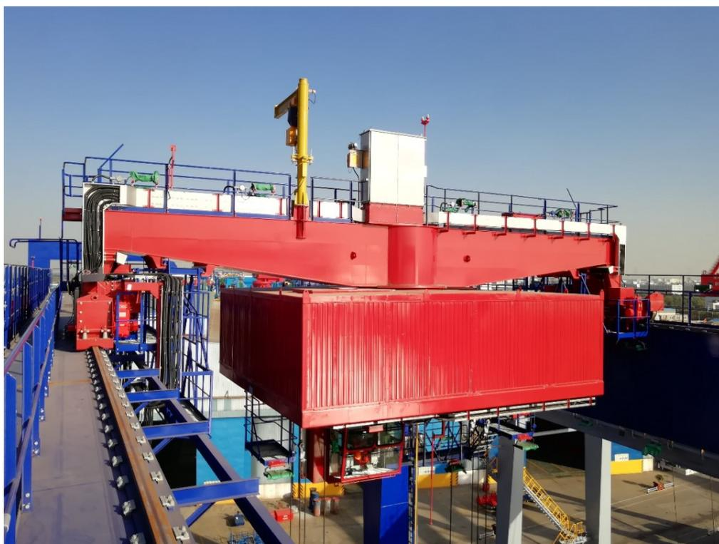
传统铁路轨道吊回转小车重量较大、环轨与车轮之间容易磨损。为进一步提高产品性能，振华设计研究总院技术团队勇于创新，研发了全新的“单梁悬挂式回转小车”。
